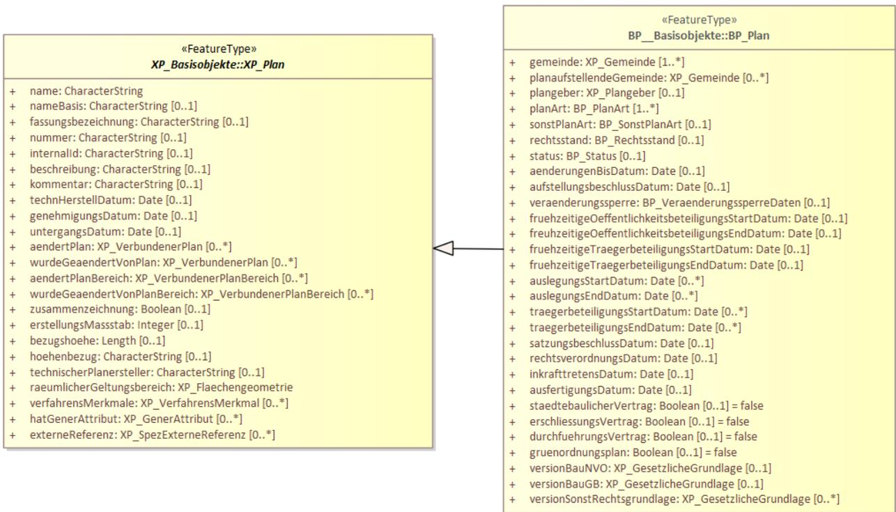
Abbildung 2: Metadaten-Attribute des BPlans (UML-Modell)
