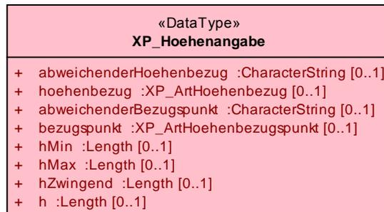
Abbildung 7: XPlanung Datenstruktur zur Spezifikation einer Höhenangabe (UML-Modell)
