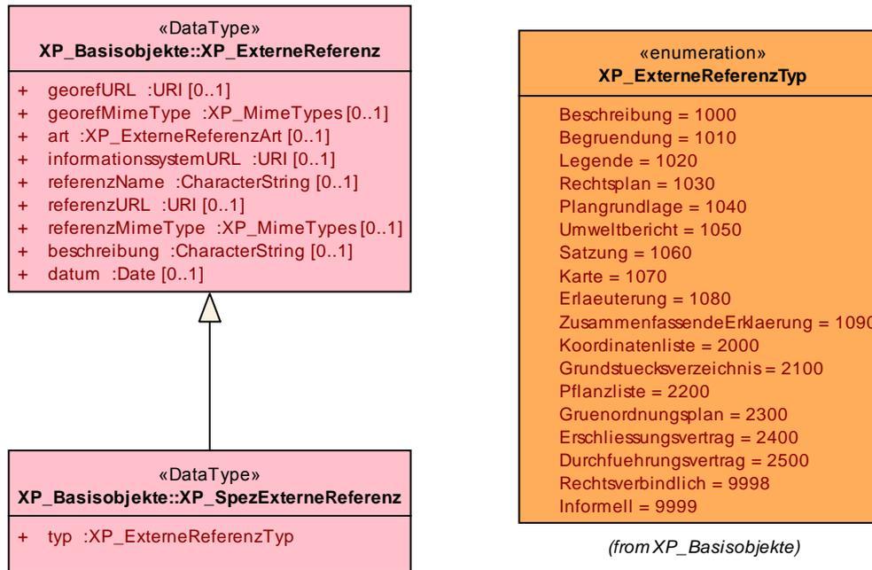
Abbildung 5: Datenstrukturen zur Anbindung externer Dokumente oder Planwerke
