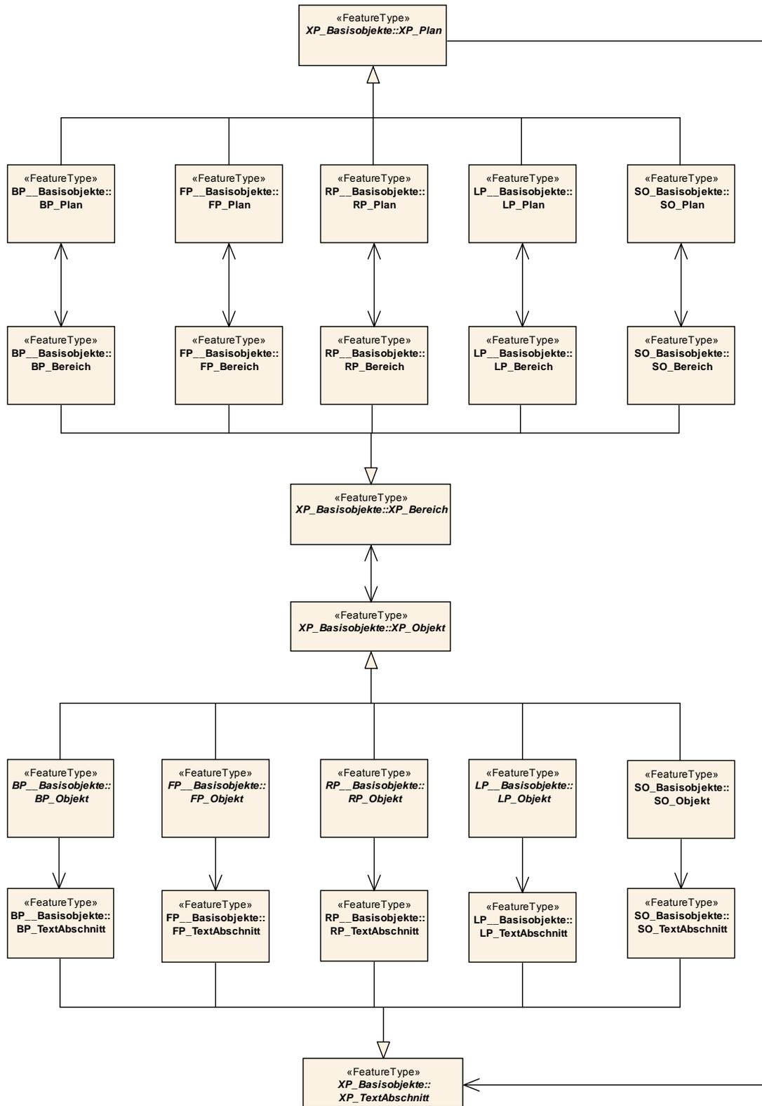
Abbildung 1: Struktur des XPlanung-Datenmodells
