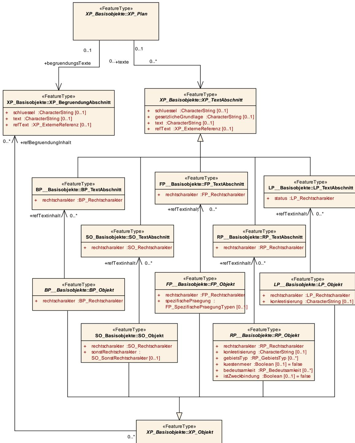
Abbildung 4: Textliche formulierte Planaussagen und Plan-Begründung (UML-Modell)
