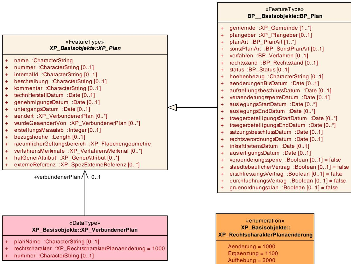
Abbildung 2: Metadaten-Attribute des BPlans (UML-Modell)
